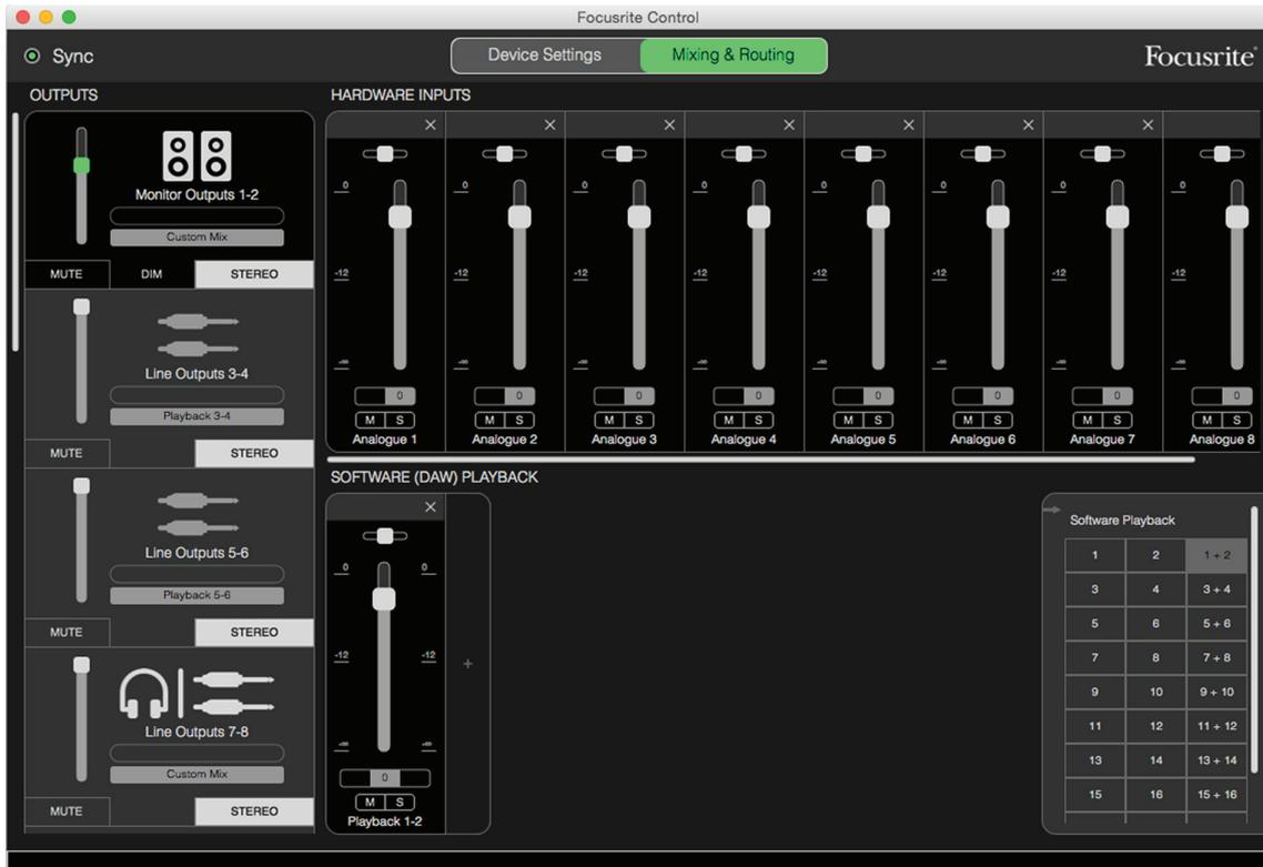
Comme avec le Preset 2 Channel Analogue, la sommation de sortie du mélangeur est envoyée aux sorties Monitor 1 et 2 et aux sorties ligne 7 à 10 sous forme de paire stéréo.
